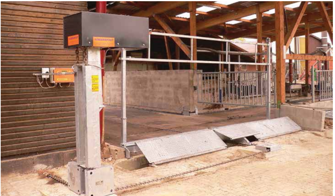
■ Kettingaandrijving op console en combischuif met oploop voor afstortklep
